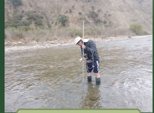
Medición del caudal
